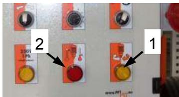
Рис. 71: Индикаторы неисправностей
