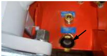
Рис. 80: Грязеулавливающий фильтр на входе воды
