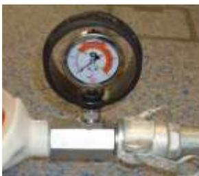
Fig. 23: Манометр давления раствора
