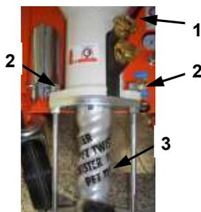
Рис. 62: Выньте блок насоса
