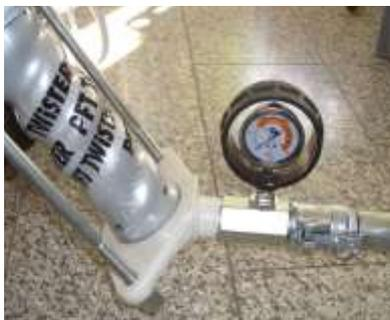
Рис. 39: Манометр давления раствора
