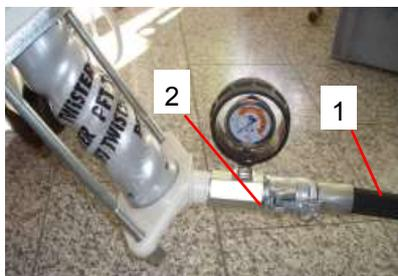
1. Соединение шланга для подачи материала (1) на манометре давления раствора (2).
