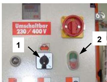
Рис. 46: Включение воздушного компрессора
