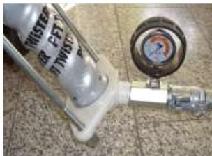
Рис. 73: Манометр давления раствора
