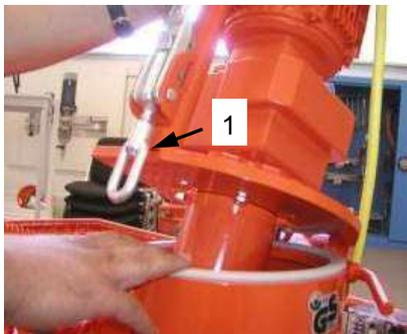
Рис. 60: Закрывать фланец наклона двигателя
