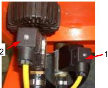
Реле давления подлежат заменены, если участились случаи их неисправности. Реле давления имеют постоянную уставку, которая не может регулироваться.
