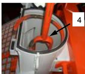
Рис. 57: Выемка смесительной спирали
