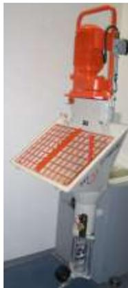
Рис. 25: Блок насоса-смесителя
