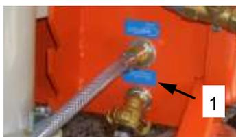
Рис. 44: Присоединение воздушного шланга
